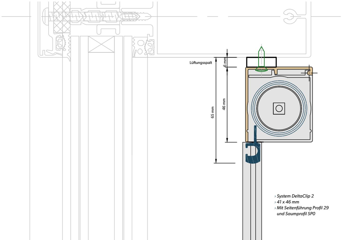
Montieren Sie den Haltewinkel durch horizontale oder vertikale Verschraubung vor. Der Rollokörper wird in das Drehgelenk eingehängt und beim Einschwenken in den Druckverschluss gedrückt. Nach dem Schließen der Kassette sind keine Verschraubungen mehr sichtbar.
